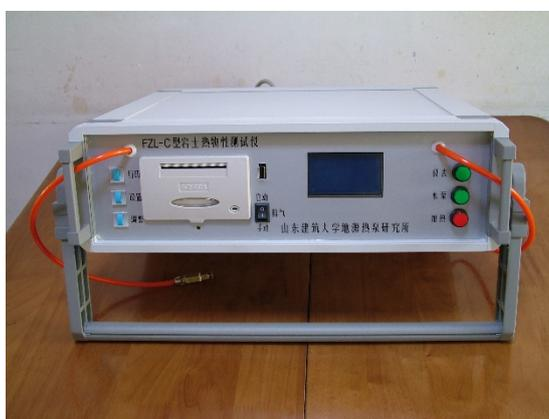
图1 便携式岩土热物性测试仪
